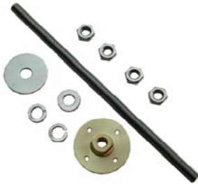
埋設固定の場合は、座金からボルトを突き出し既存の床面に開けた穴にボルトを差し込みエポキシボン드로固定
